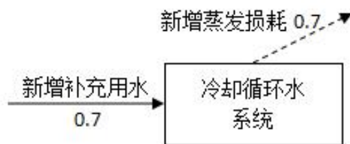
图 2-1 项目水平衡图 ( \text{m}^3/\text{a} )
